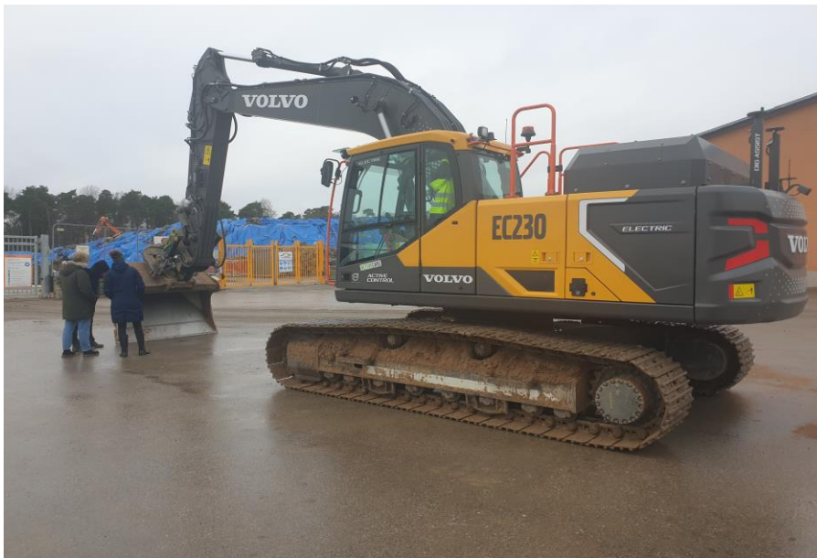
Figur 4. Den elektriska grävmaskin som användes på Hallvägen i Slakthusområdet.
